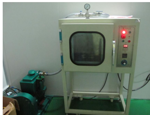
图 3.5 配胶子工序之抽真空机
