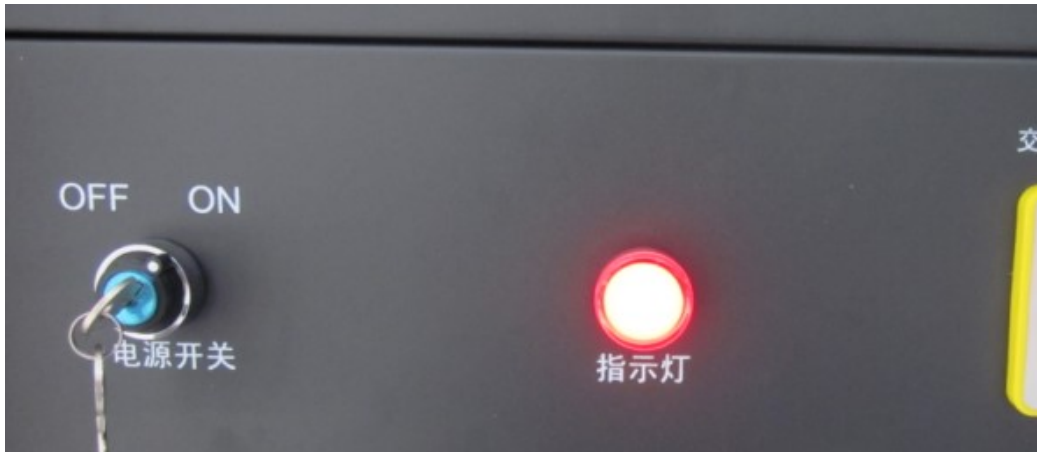
图 5.7 系统柜电源开关
