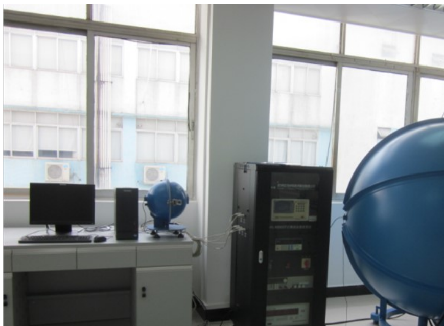
图 5.1 LED 光色电综合测试系统
