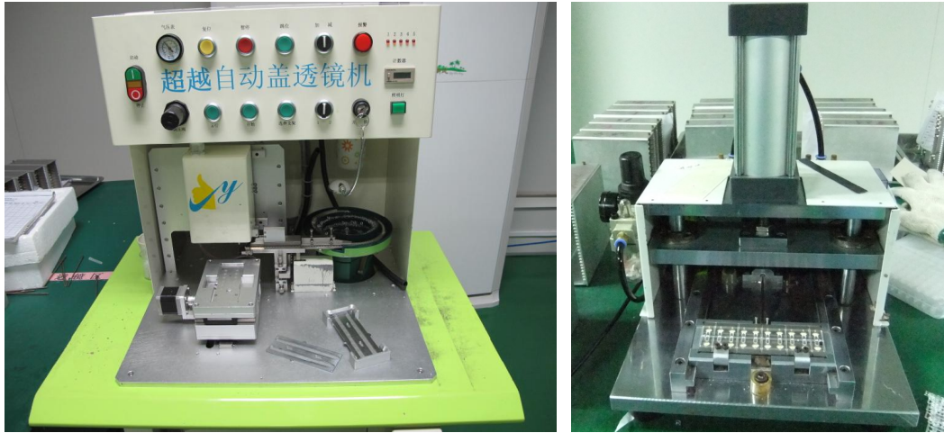
图 3.9 自动盖透镜机 左：分立型 右：透镜片型
