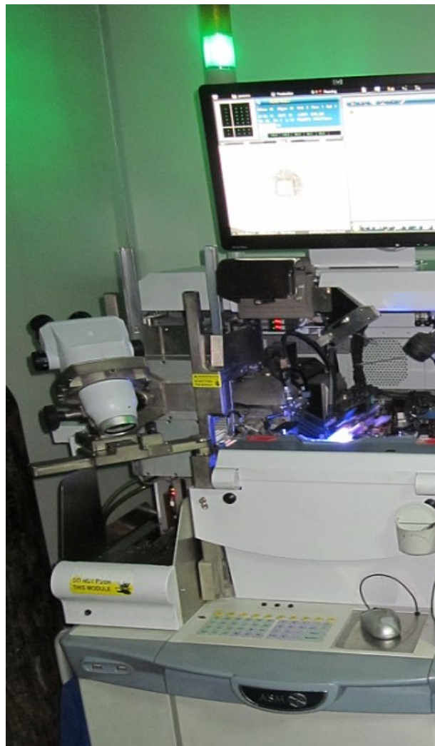
图 2.1 ASM 自动焊线机
