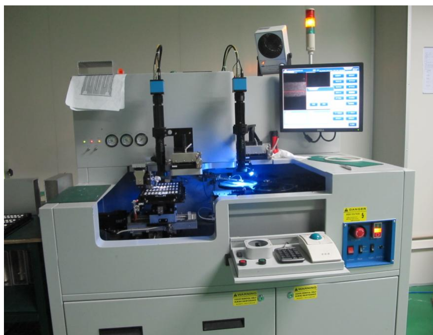
图 1.2 晶驰高速自动固晶机
