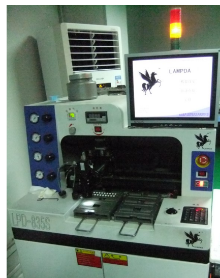
图 3.7 整体机器型自动点胶机
