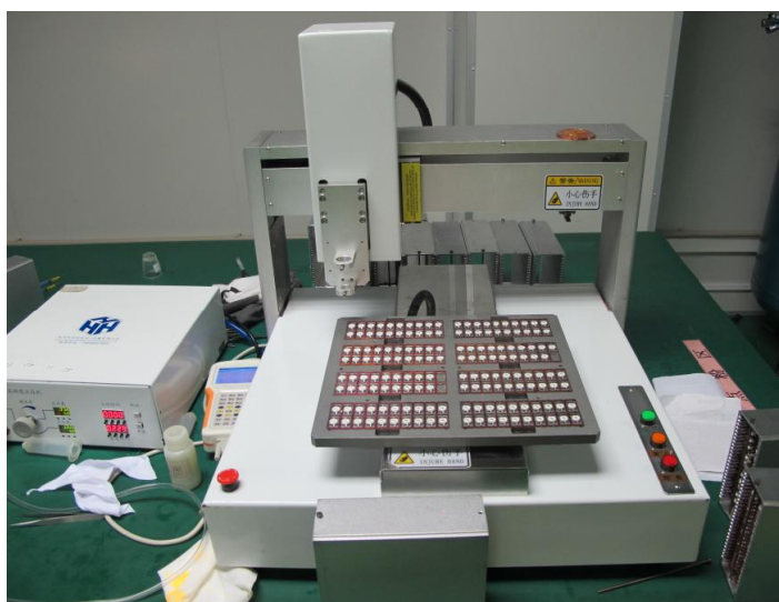
图 3.6 分立仪器型自动点胶机
