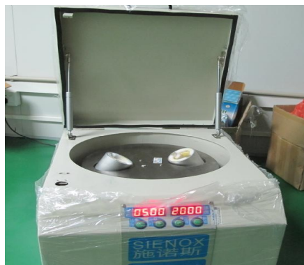
图 3.4 配胶子工序之搅拌（自动搅拌机）
