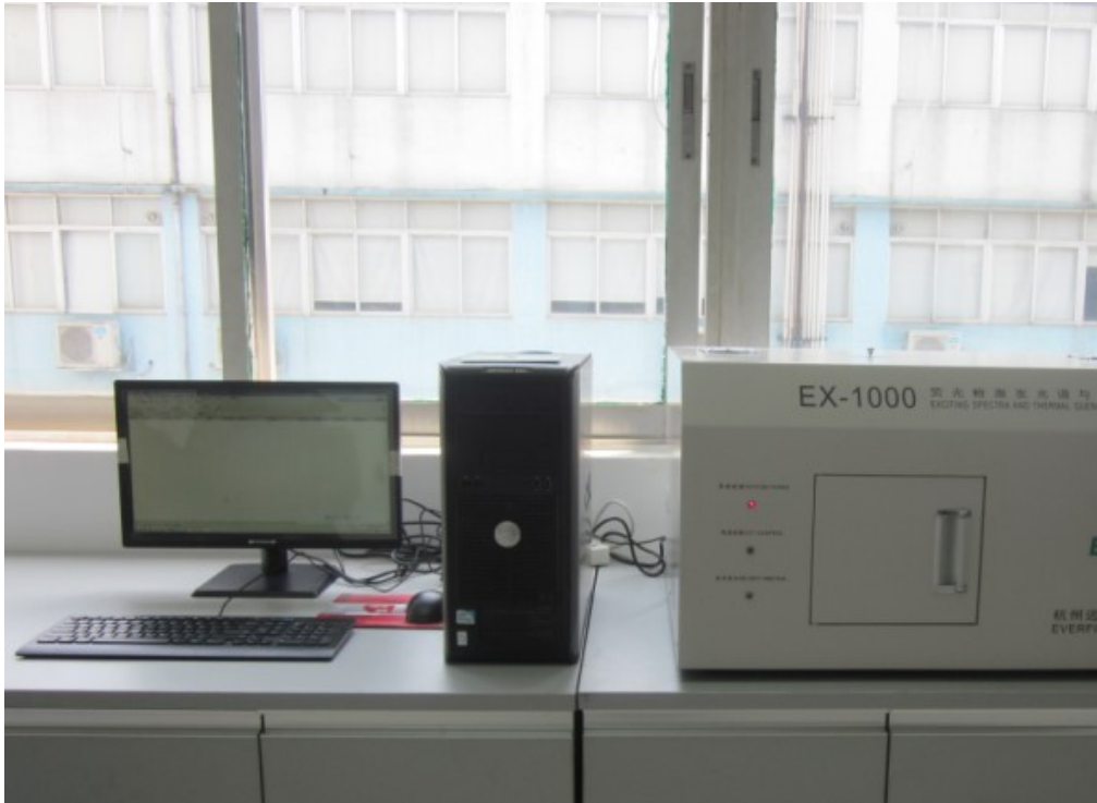
图 5.10 荧光粉激发光谱与热猝灭分析系统全景图
