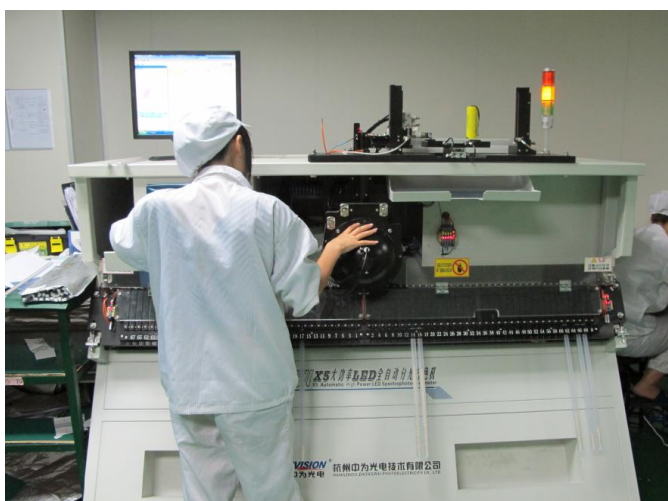
图 4.2 大功率 LED 自动分光机
