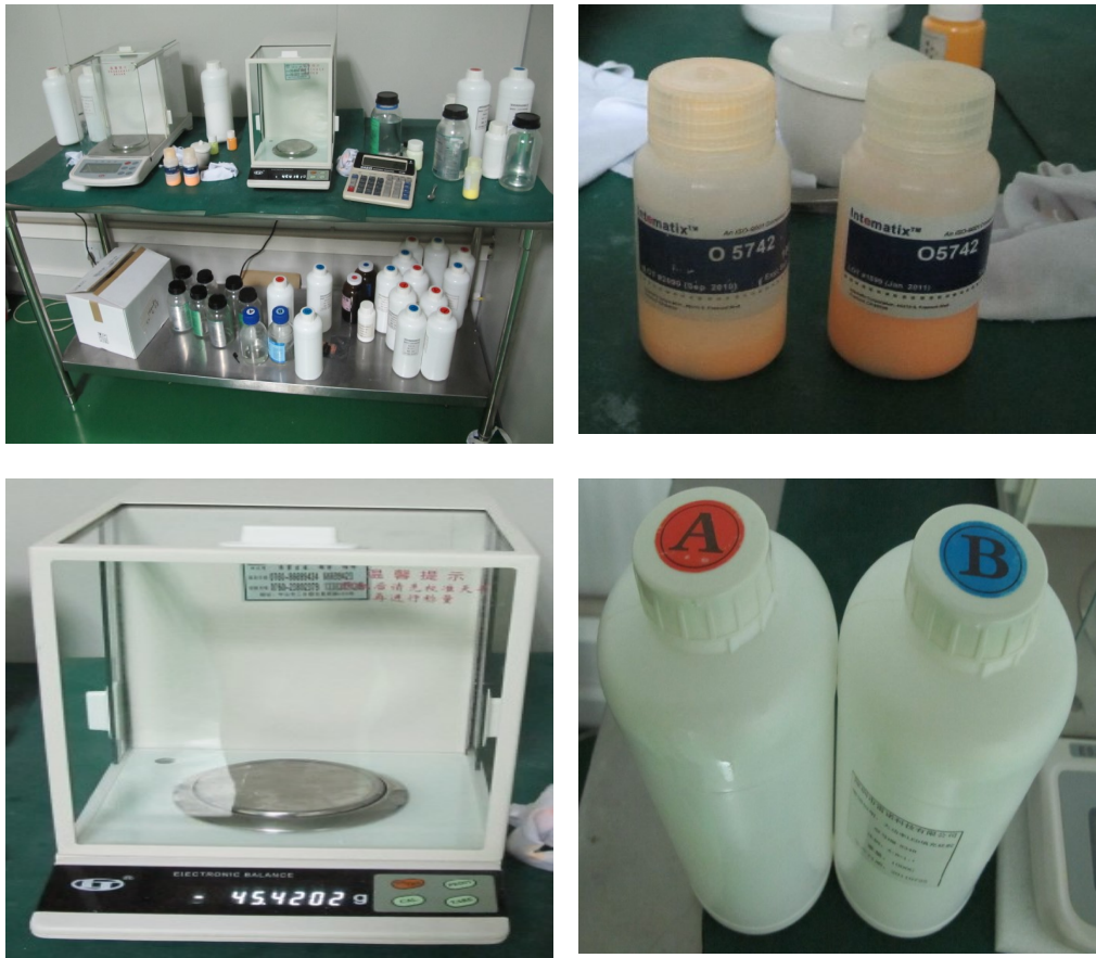
图 3.3 配胶子工序之电子天平称量物料
