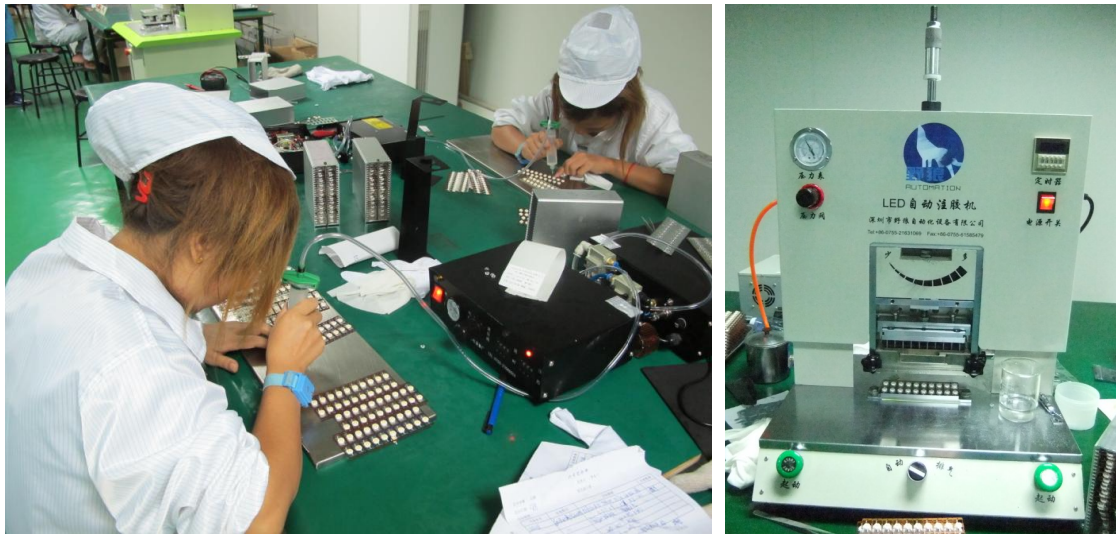
图 3.11 灌胶设备与操作 左：手动 右：自动
