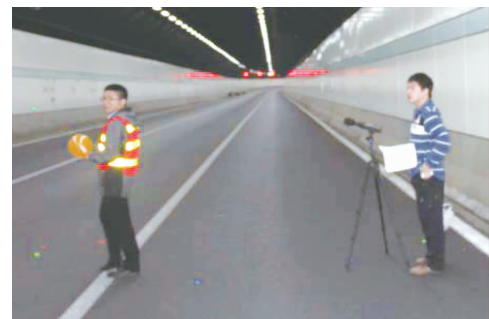
测试过程中利用气球爆炸声作为无定向脉冲声源。
