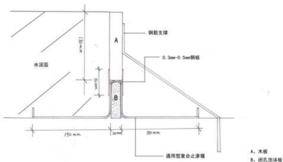
图 B.1 典型地面施工缝施工示意图
