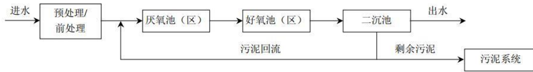
图 B. 3-2 厌氧好氧工艺流程图
