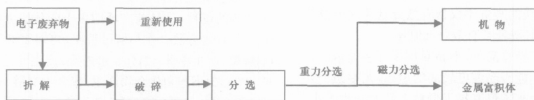
图 1 电子废弃物机械回收流程
