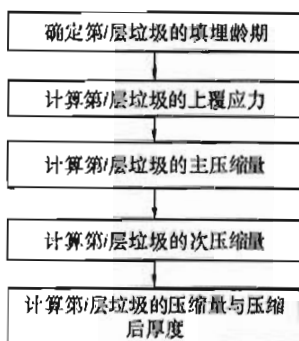
图 A. 0. 1-2 t 时刻第 i 层垃圾压 缩量的计算流程
