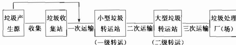
图 2 二级垃圾转运系统工艺路线
