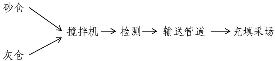
图 28 尾矿胶结充填工艺流程
