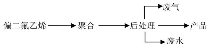
图 10 典型的氟树脂工艺流程示意图
