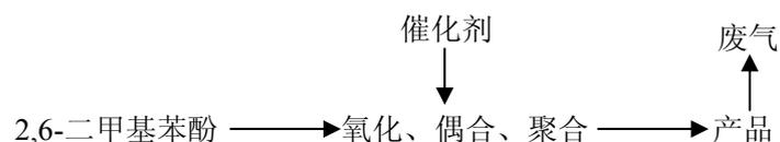
图 16 聚苯醚树脂工艺流程示意图
