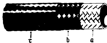
图 8-48 高压软管 a—内管, TPU PES 85; b—钢丝编织层; c—外套层, TPU PES 85
