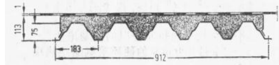
图 6-45 “Thyssen-thermodach” 构件的断面
