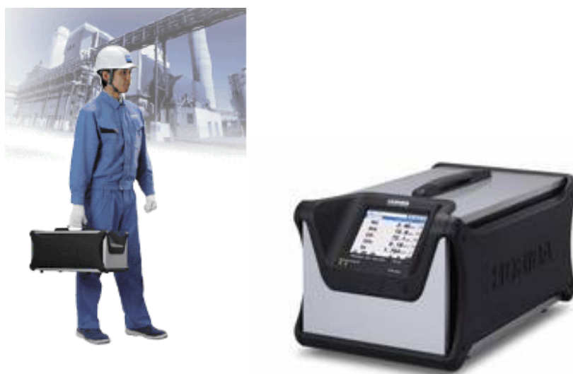
图 5 光学法便携气体分析仪的实例
