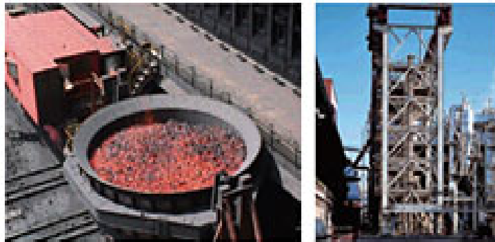
照片 2.5-1 新设节能形 CDQ 的事例 (出处:J 公司环境报告 HP)
