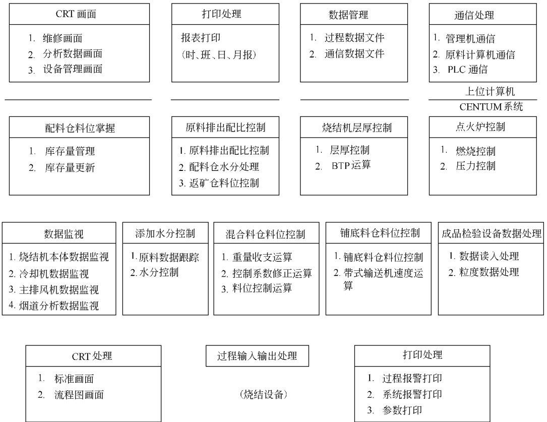
图 12-27 用于烧结厂的带上位机的 CENTUM 系统功能概略图
