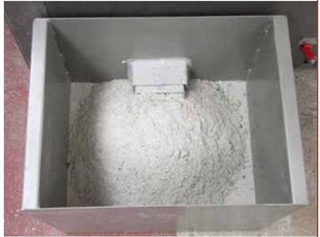
图 2.3 飞灰是从烟灰净化中产生的灰分（左图）底灰存入存储罐中（右图）
