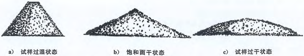
图4 天然砂饱和面干状态示意图
