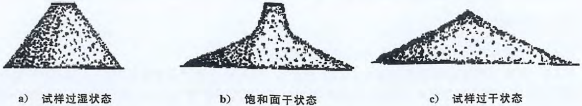
图5 机制砂饱和面干状态示意图
