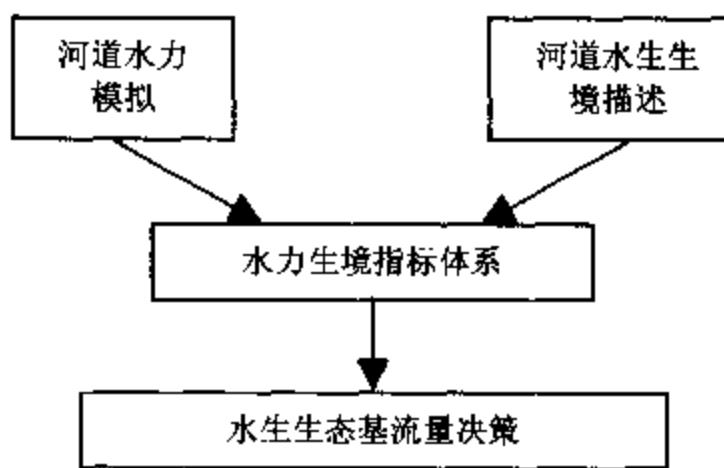
图 4 生态水力模拟法的示意框图
