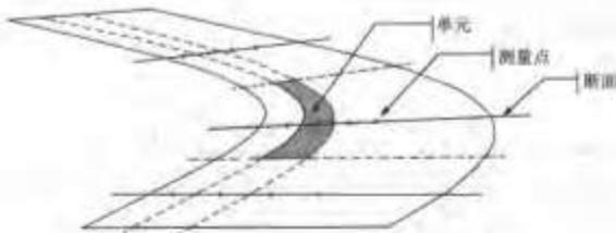
图 3 PHABSIM 模型中河道断面分隔
