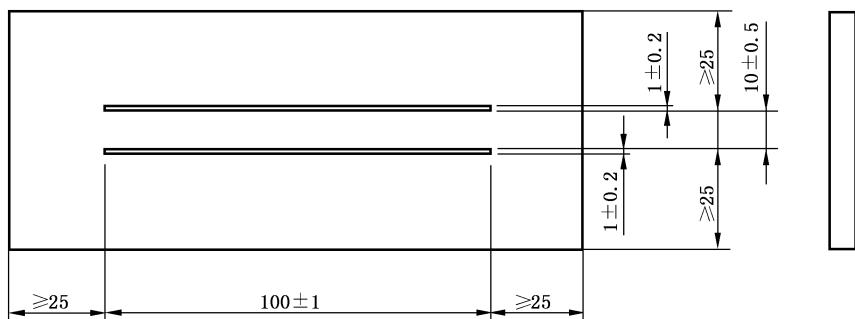
图 4 涂导电漆电极的试样
