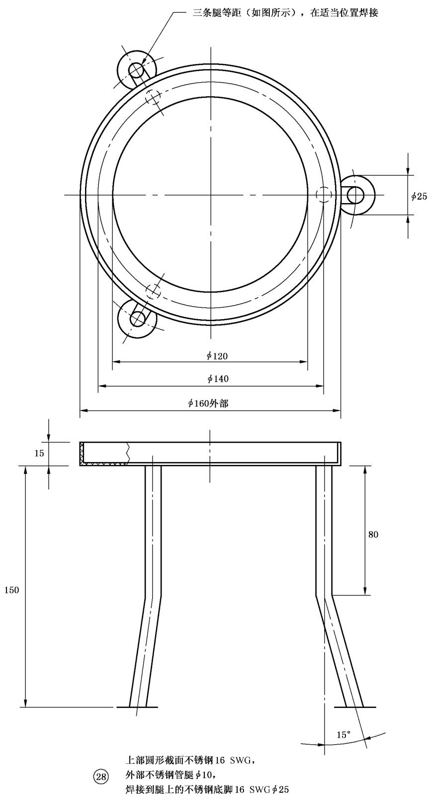
图 B.9 炉架底座
