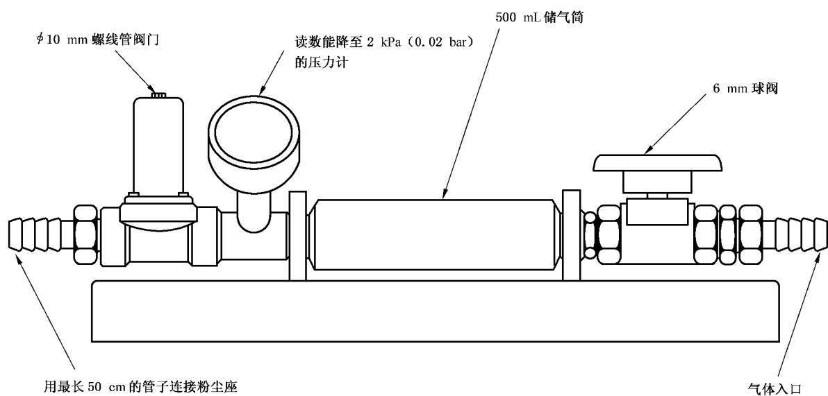
图 B. 10 粉尘喷撒系统(方法 B)
