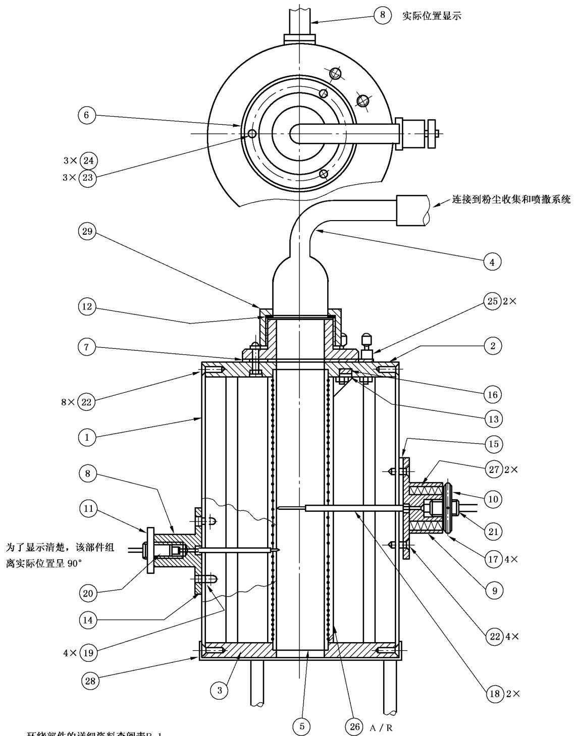
图 B. 1 恒温炉装置组件(方法 B)
