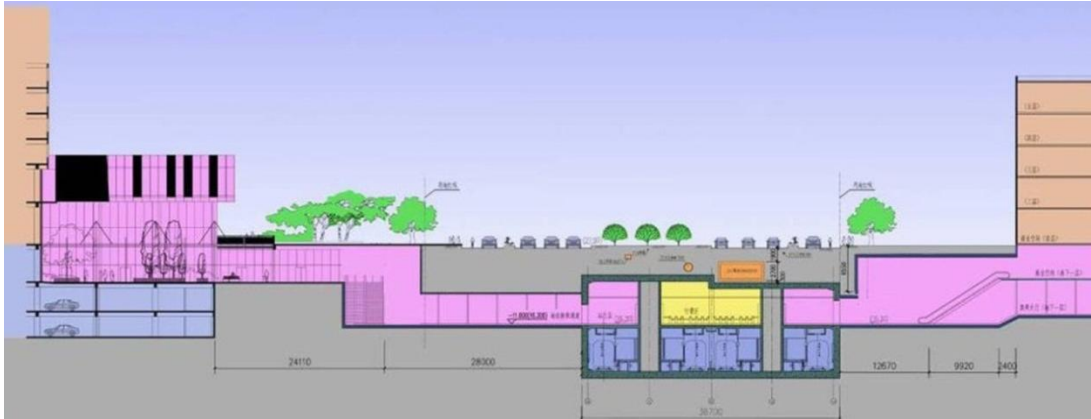
图7.18 通过轨道站厅层衔接道路两侧物业开发的地下空间
