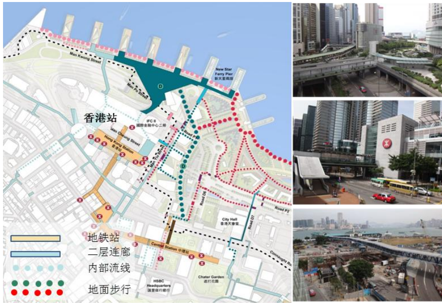
图6.11 架设二层连廊延伸轨道站点服务范围、优化步行环境
