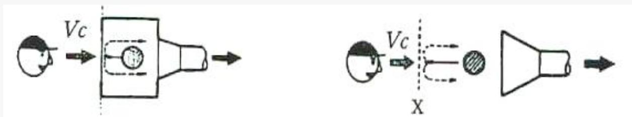
为保证污染物全部吸入罩内，必须在距吸气口最远的污染物散发点（即控制点）上造成适当的空气流动。除外部排风罩以外，控制风速和面风速均相同，不同类型的排风罩，控制风速均不同。
