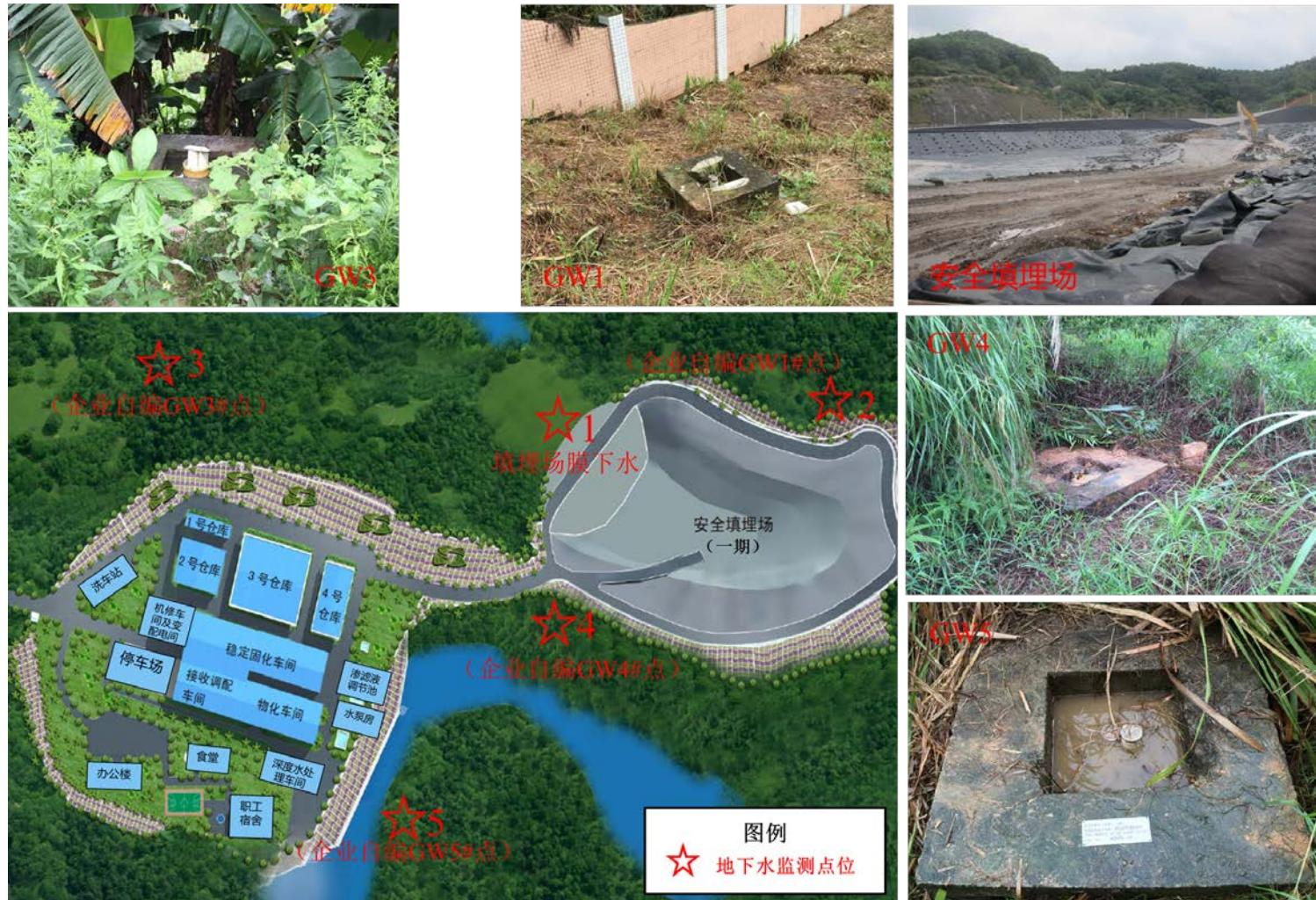
图 3-4 项目平面布置示意图及地下水监测点位
