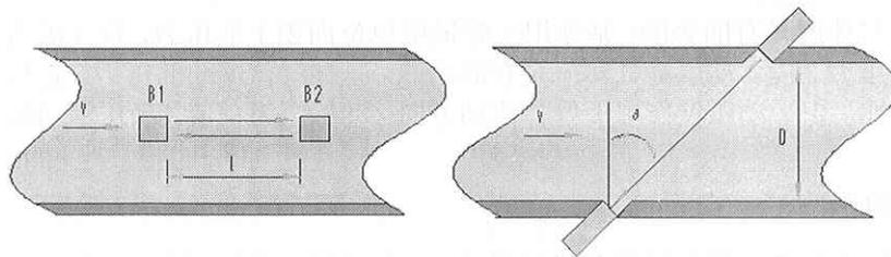
图 11-10 超声波流速仪测量原理示意图
