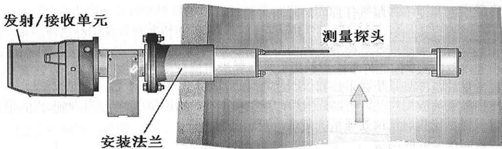
图 11-3 内置式直接测量法 CEMS 示意图
