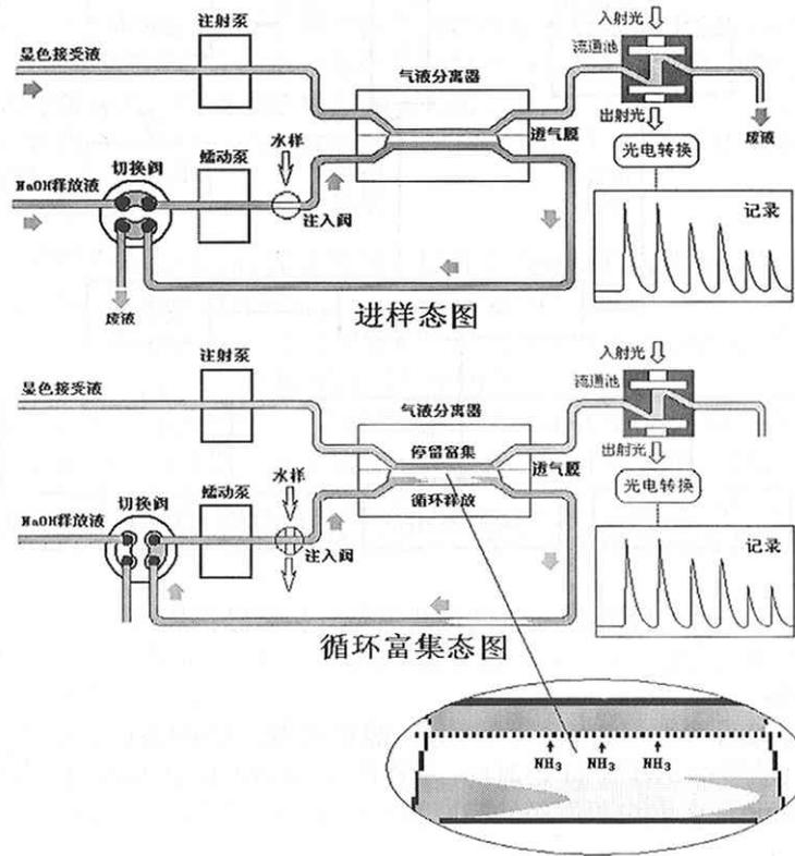
图 8-12 流动注射比色法氨氮自动监测仪结构原理
