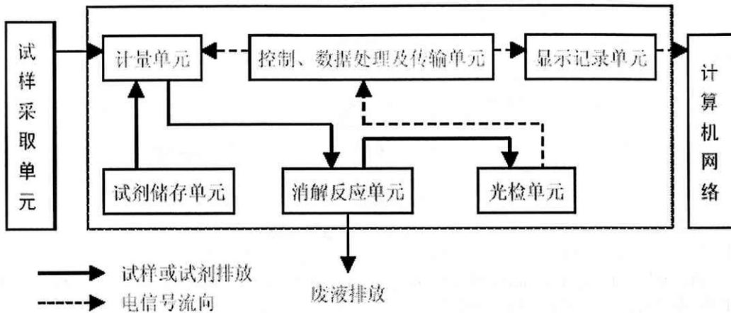
图 8-6 重铬酸钾氧化法 COD 自动监测仪结构
