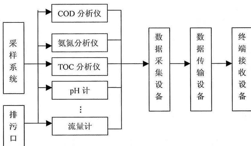
数据采集设备主要是对各种监测设备测量的数据进行采集、存储及处理。它不仅具有自动记录功能,同时还能够对排污单位环保设备的运行状况进行自动监测,并将有关的数据存储和输出。
