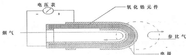
图 11-7 氧化锆含氧量自动分析仪测量原理示意图
