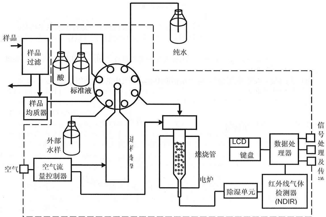
图 8-7 燃烧氧化-红外吸收法 TOC 自动监测仪流程图
