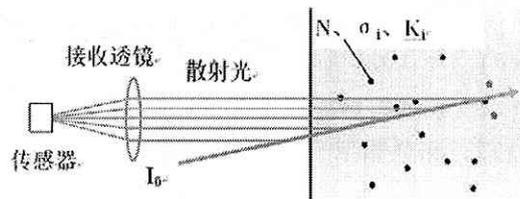
图 11-6 后散射法颗粒物分析仪光路示意图
