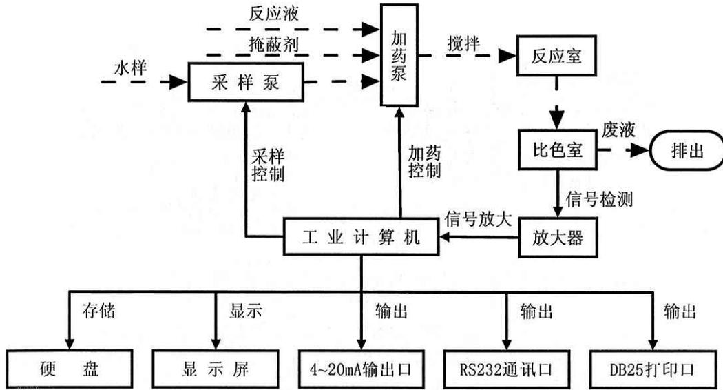
图 8-11 纳氏比色法在线氨氮分析仪结构原理
