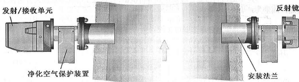
图 11-4 外置式直接测量法 CEMS 示意图
