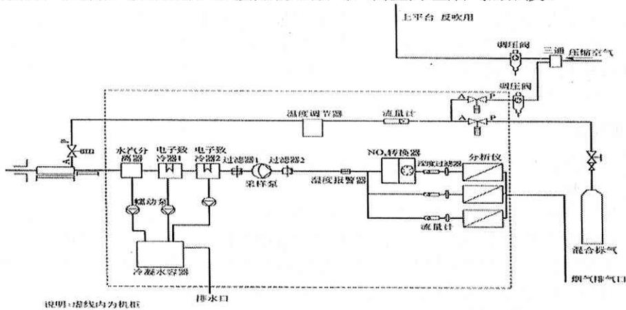
图 11-1 直接抽取法自动监测仪典型气路原理图
