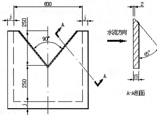
图 8-2 直角三角堰构造
