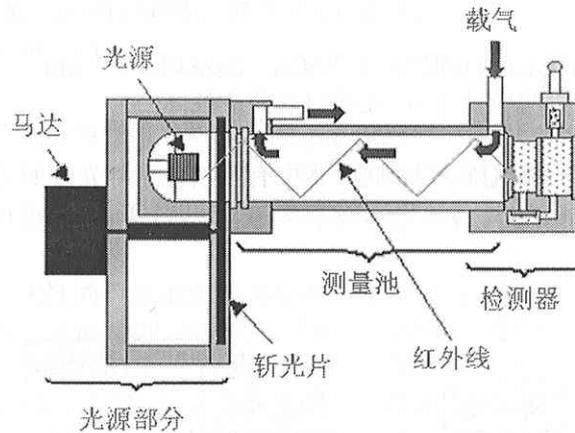
图 8-8 燃烧氧化-红外吸收法 TOC 自动监测原理图
