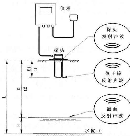
图 8-13 超声波测量原理
