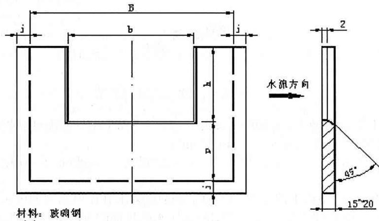
图 8-3 矩形堰板构造
