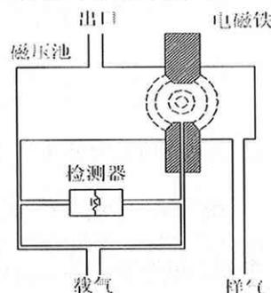
图 11-8 顺磁含氧量自动分析仪测量原理示意图
