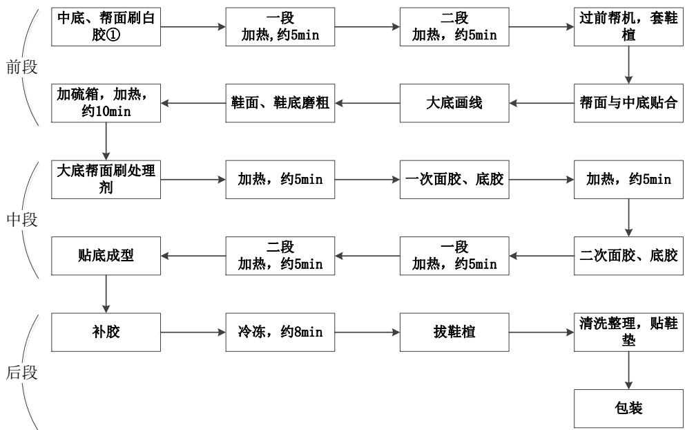
图 2 贴底成型工艺流程图
