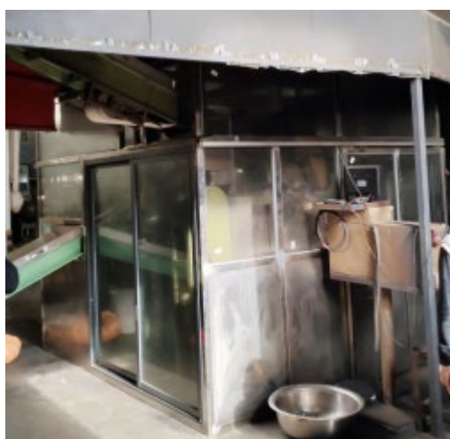
图 2.3-9 压延高温加热辊轴工段收集情况
