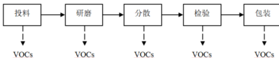
图 3.1-2 油漆生产工艺流程简图
