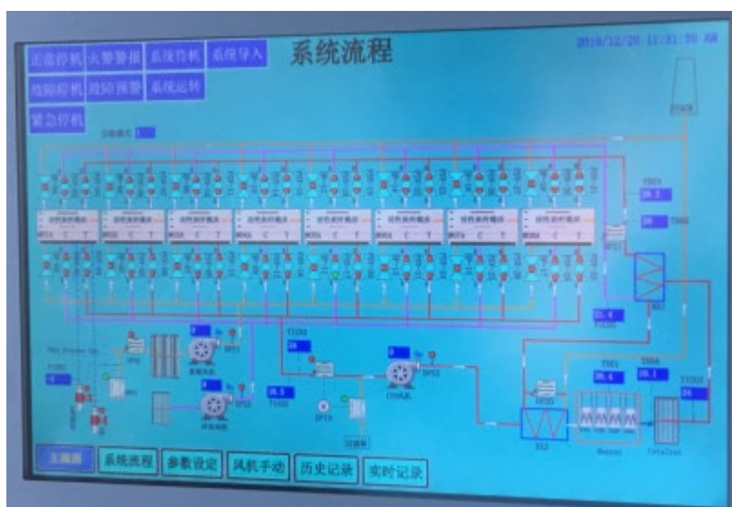
图 3.5-2 活性炭纤维吸附+催化燃烧处理系统中控监控系统
