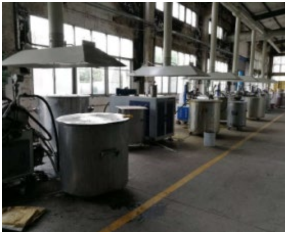
(d) 油性油墨研磨工序现场密闭情况
