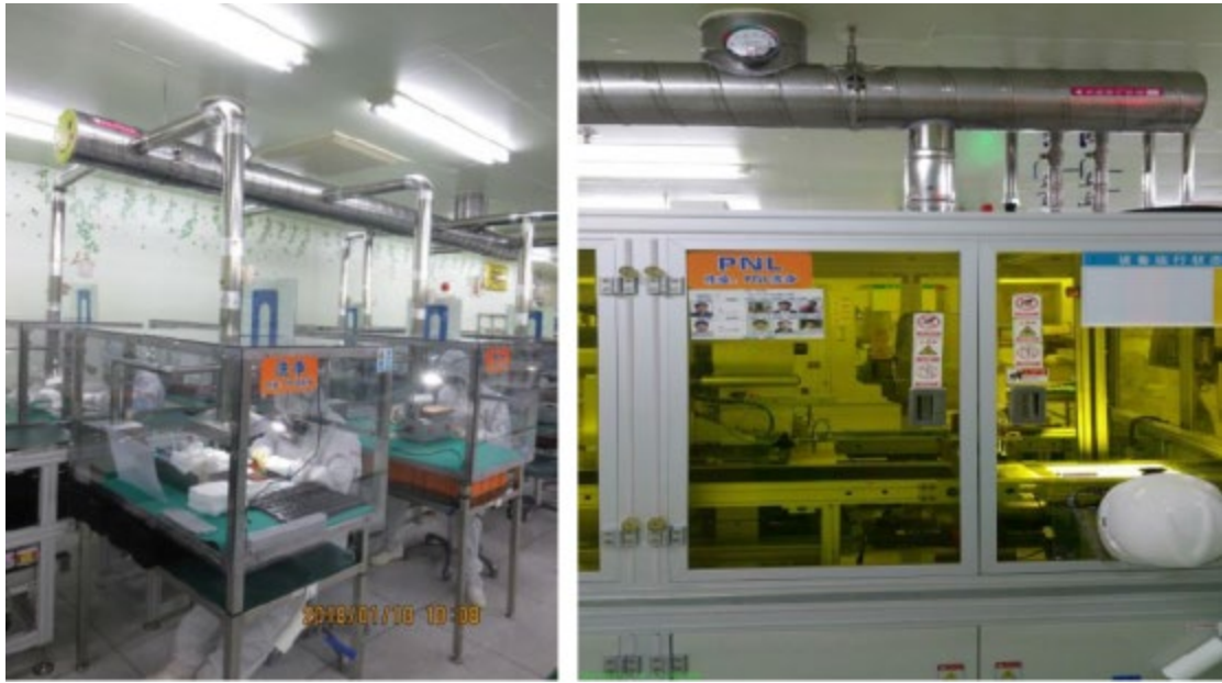
图 2.1-5 再作业手动洗净拆分台及自动设备洗净装置
