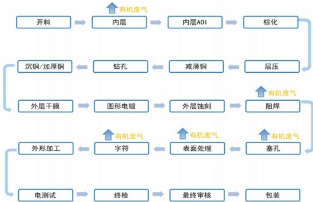
图 2.1-6 生产工艺流程及 VOCs 产污环节
