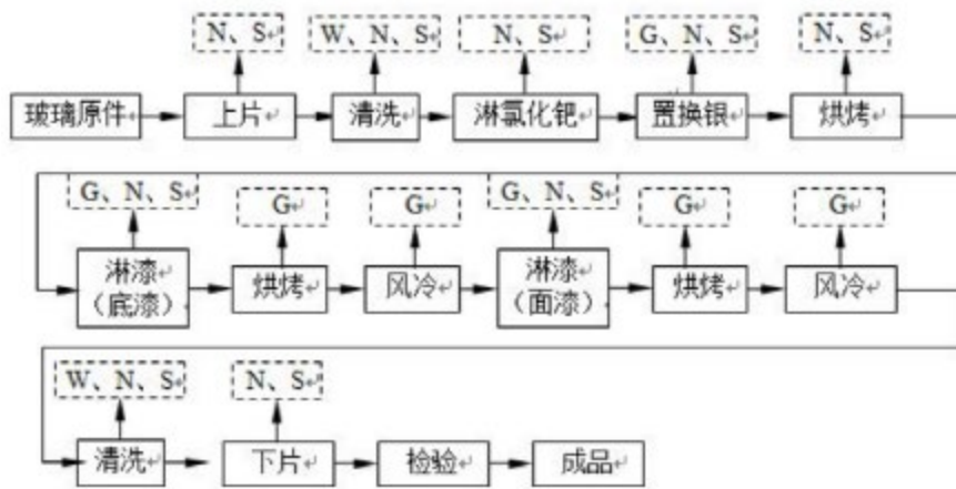
图 3.6-1 镜板加工生产工艺流程图
