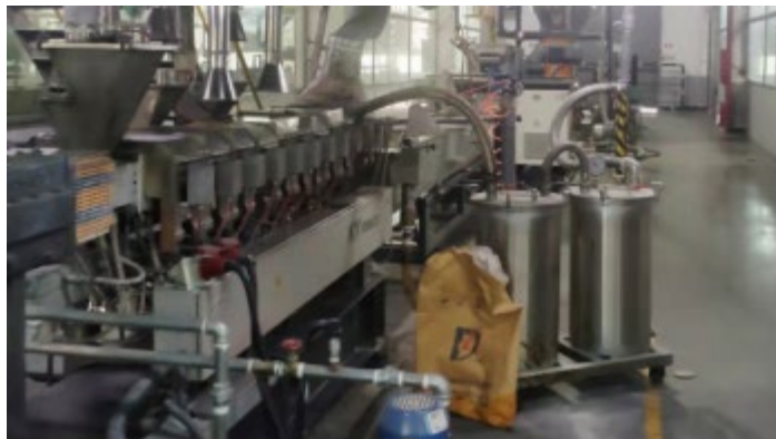
图 2.3-7 双螺杆挤出机末端真空泵连接及油污暂存罐
