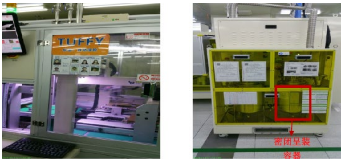
图 2.1-4 防湿胶涂敷（密闭作业）及 UV 胶 VOCs 收集和密闭容器存放
