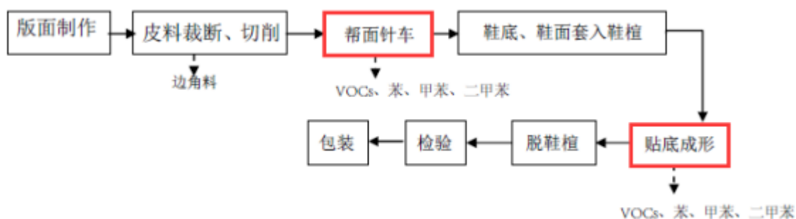
图 2.4-1 制鞋总工艺流程图
