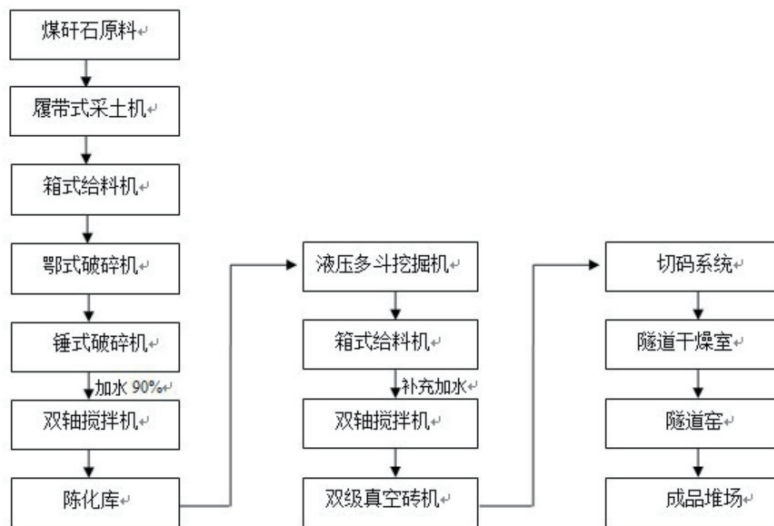
图 5-11 多孔砖生产工艺流程图
