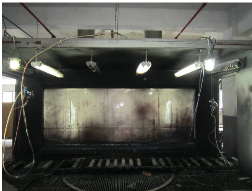
水帘喷涂工房
