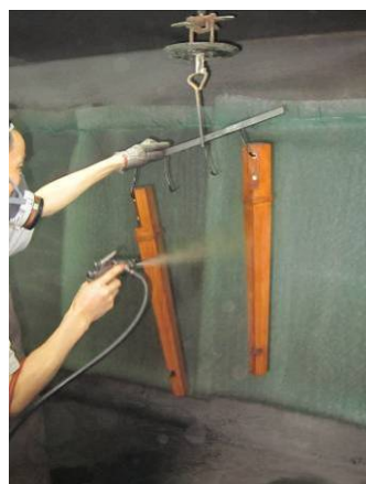
喷涂工房的过滤装置
