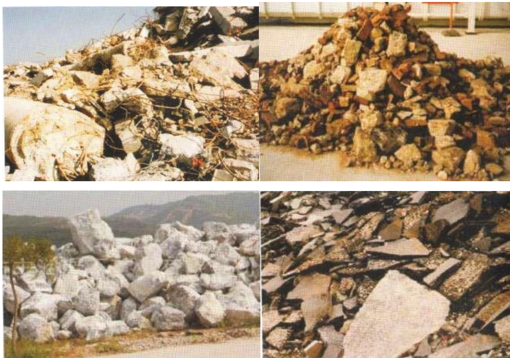
图 5.1-1 可再生利用的建筑废弃物
