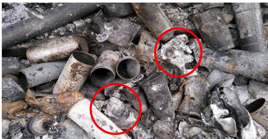
图 8 戳罐作业附近货品架位置火灾后图片 注：图中红圈处为铝罐燃烧后的铝锭
