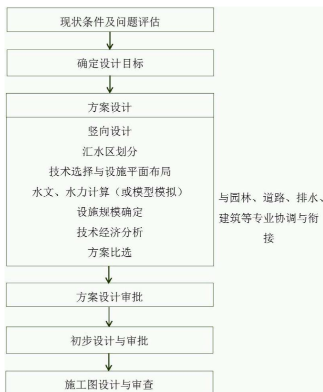
图 6-1 海绵城市项目设计流程
