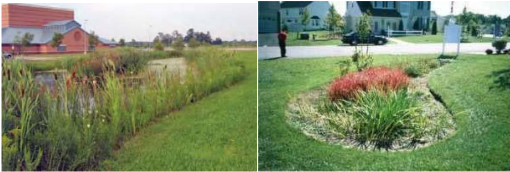
图 2-11 表面流雨水湿地和小型潜流雨水湿地实景图
