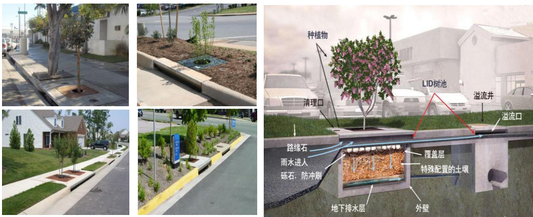
图 2-9 生态树池实景图 and 构造图
