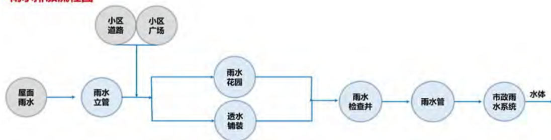
图 6-5 雨水排放流程图
