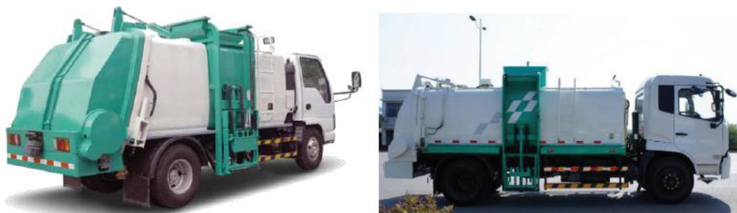
图 10-1 桶装式密闭厨余垃圾收运车示例图
