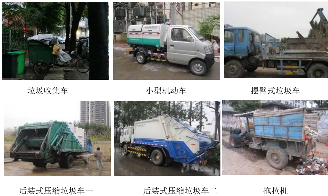
图 2-6 规划区现状城镇生活垃圾运输车辆现场图
