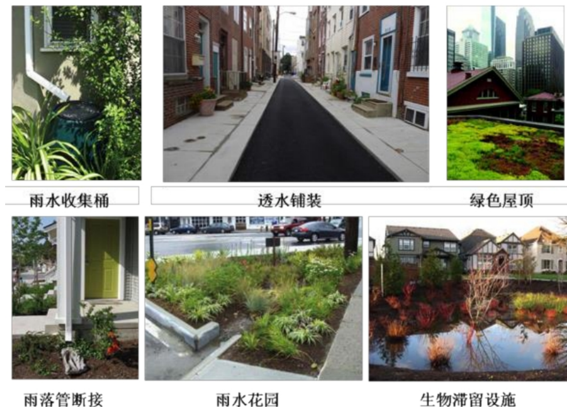
图 6.5-1 海绵城市雨水利用措施图
