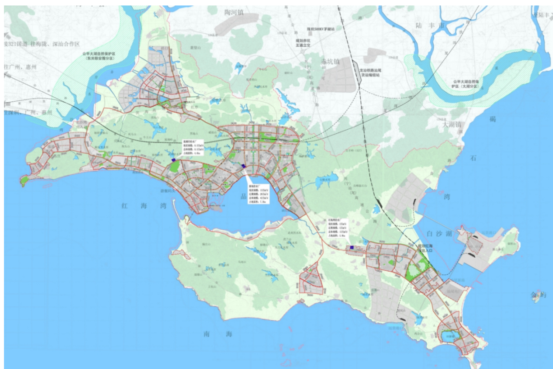
图 6.2-1 汕尾市城市供水管网规划图
