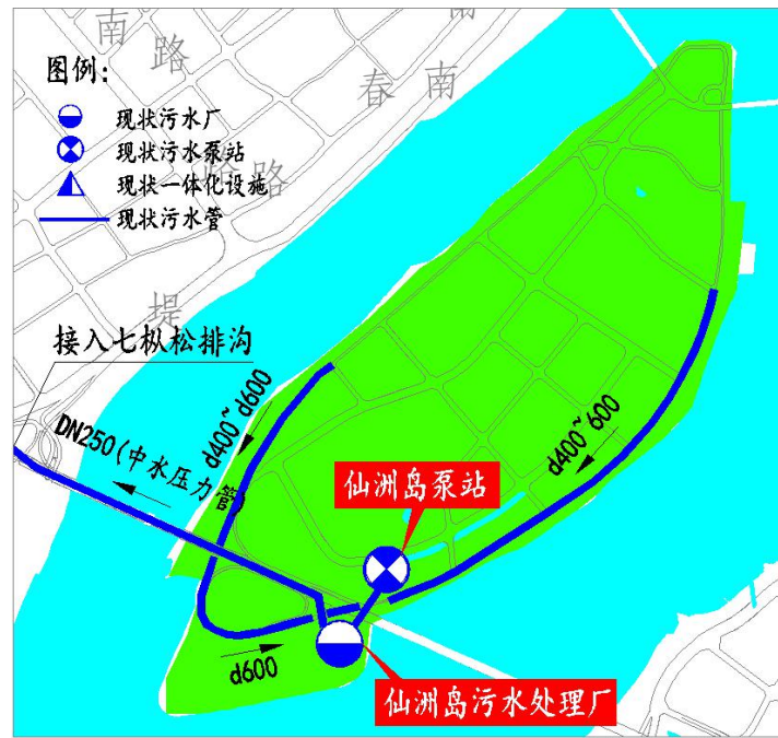
图 3.2-19 仙洲岛现状排水管网布局图
