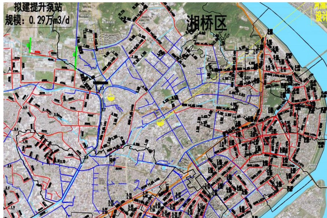
图 7.4-7 湘桥区近期污水管网布置图
