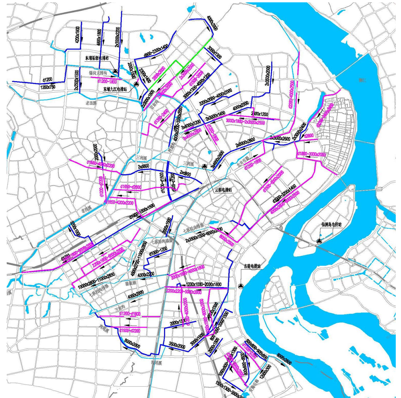
图 8.4.4-1 区域规划雨水通道布置图
