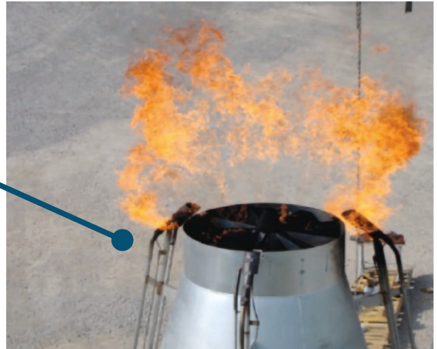
图7b: 具有多个楔形流动截面的空气辅助废气火炬, 在空气流和废气流之间交替
