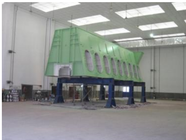
图 3-2 密闭喷涂和固化在造船厂分段涂装中应用
