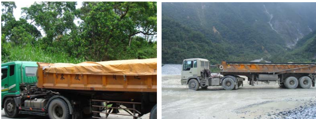
圖3-17 砂石車貨箱覆蓋防塵布(網)實照
