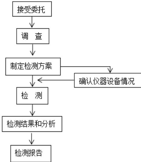
图 3.0.1 海绵城市建设工程检测工作流程框图
