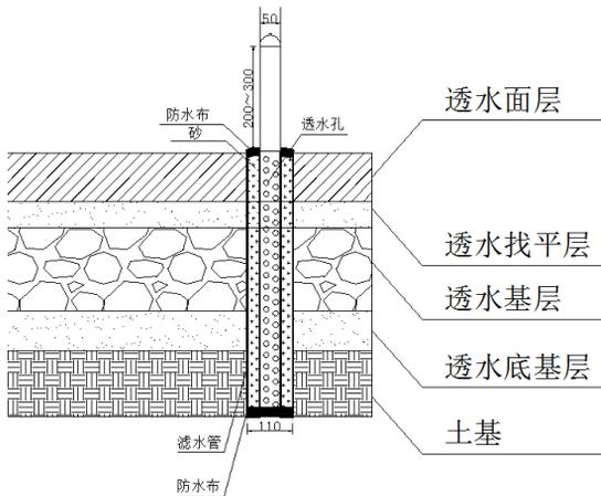
图 E.0.2 观测管测定图 (单位: mm)
