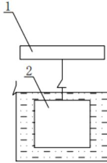
图 A.0.2 试件在水中试验示意图
