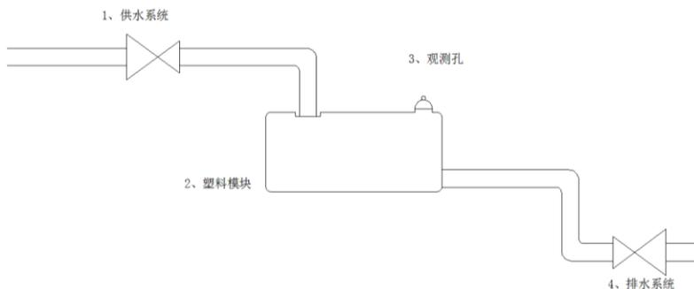
图 F.0.2 塑料模块排空时间测定图
