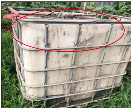
❌ 室外存放,未防雨防渗
