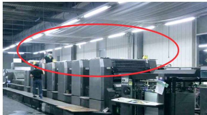
❌ 印刷机未安装废气收集设施
