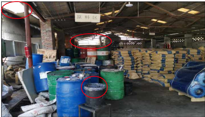
❌ 库房未密闭，有机溶剂桶未密封
