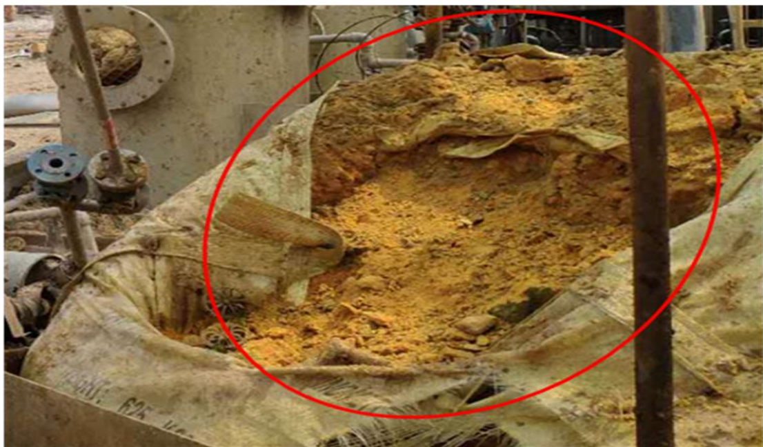
图 2 事故现场发现的硝化废料
