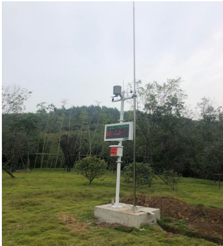
扬尘监控装置
